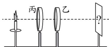
步驟3. 模擬矯正近視眼：挑選適當的凹透鏡丙，表示矯正用的近視眼鏡，放置在凹透鏡乙與蠟燭之間的固定位置，使其在屏幕上成像清晰。
