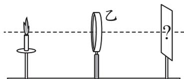
步驟2. 模擬近視眼的成像情形：在凸透鏡甲的位置改放凹透鏡乙，表示近視眼睛的水晶體，凹透鏡乙與凸透鏡甲的焦距相同，屏幕上成像模糊。
